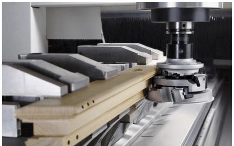
*Das flexible Spannsystem von Weinig ist zentral für die Stabbearbeitung im Durchlaufverfahren.*
